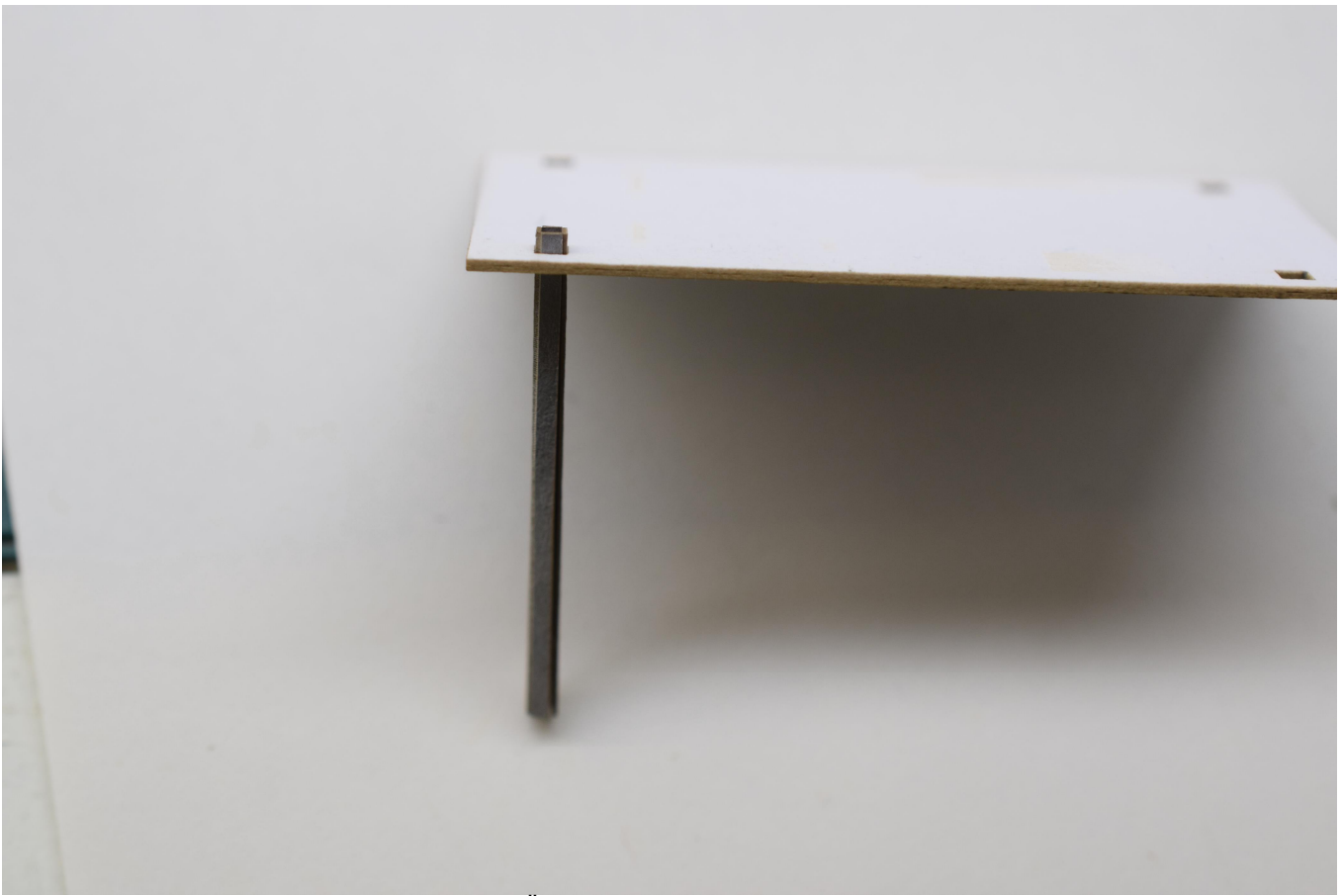
Bild 3 Dann den Steher ca. 10mm durch die Öffnung vom Boden schieben.
