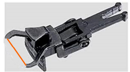
Der Ausschnitt wird durch einen 0,5mm Messingdraht ersetzt, (eingelötet von unten) The cutout is made by a 0.5mm brass wire replaced, (soldered from below)
