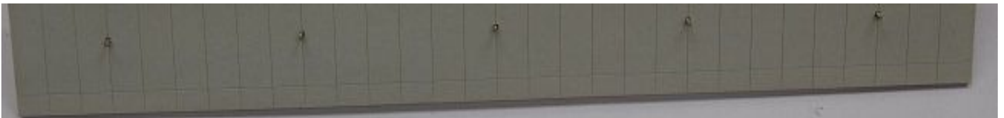
Bild 11 fertig geklebte Blitzableiter
