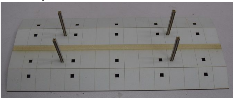
Bild 5 Der Unterbau wird auf das Gerüst geschoben und geklebt
